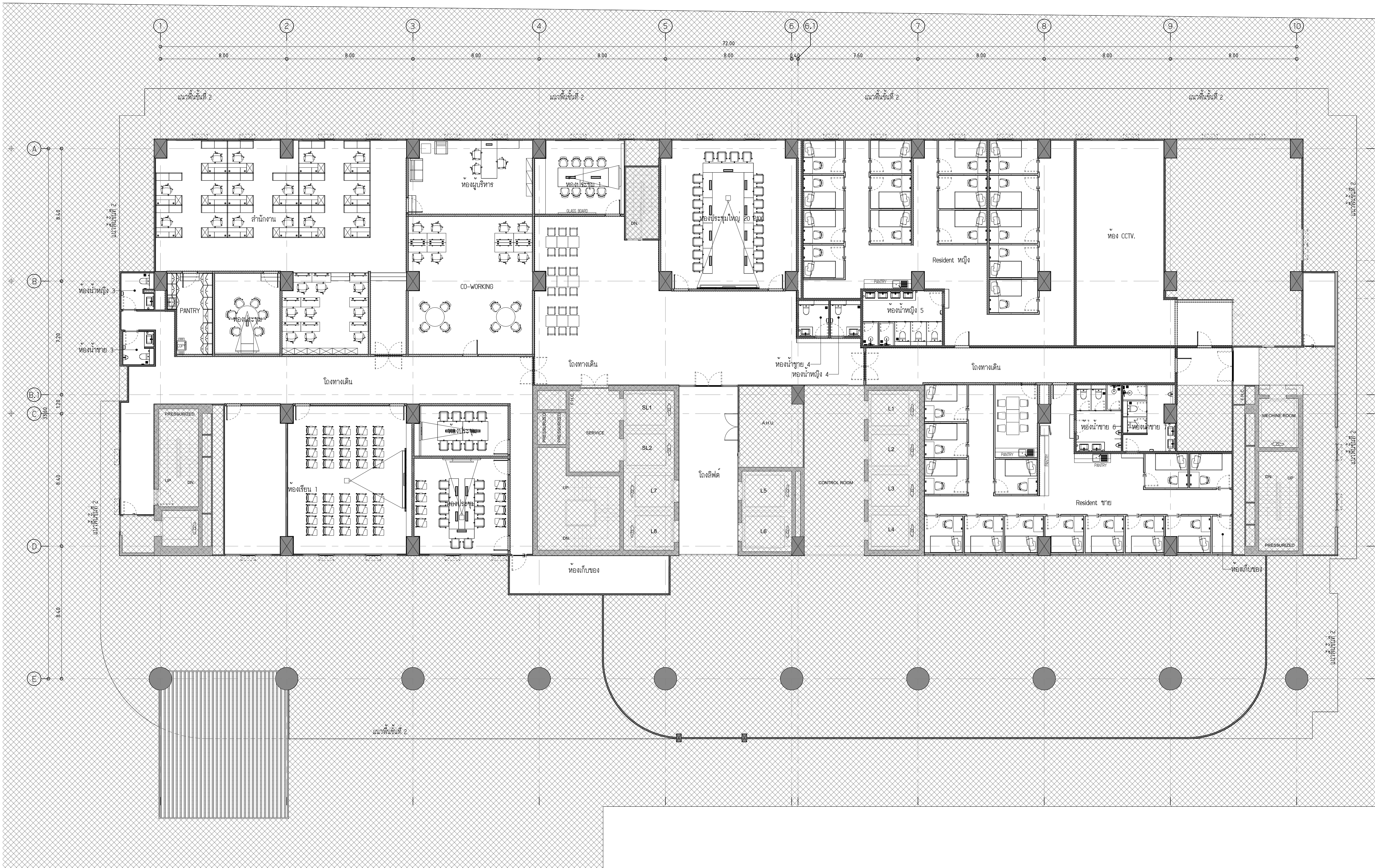
1 แปลนวัสดุกันไฟลาม ชั้นลอย (หลังปรับปรุง) SCALE (A1) 1 : 125 หมายเหตุ : แนวแสดงตำแหน่งถังไฟไหม้
